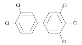
e) PCB 105 (2,3,3',4,4'-pentachlorobiphenyl)
